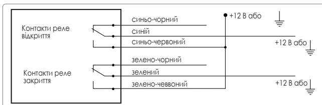
Схема підключення до дводровитим приводам системи управління
