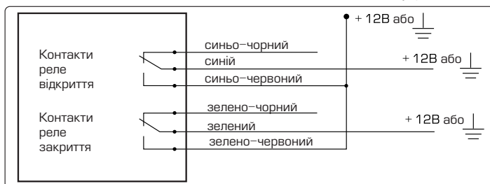
Схема підключення до системи з позитивним або негативним управлінням
