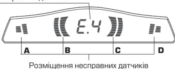
При увімкненні задньої передачі, система проведе самодіагностику і перевірить працездатність датчиків.
