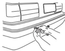
Накерните место установки датчика, чтобы избежать соскальзывания сверла.
