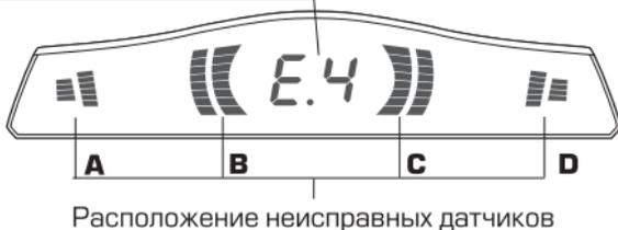
При включении задней передачи, система проведет самодиагностику и проверит работоспособность датчиков.
