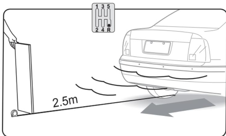
Проведите функциональный тест, используя деревянную доску (0.3м x 1м), установленную за автомобилем. Медленно сдвигая назад, проверьте работоспособность каждой функции, указанной в данном руководстве.
