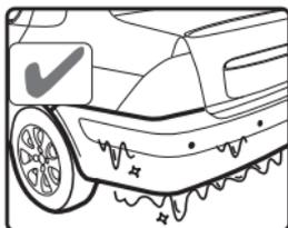
Якщо датчики вкриті льодом, розтопіть його теплою водою.
