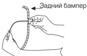
Надежно закрепите датчик в сделанном отверстии
