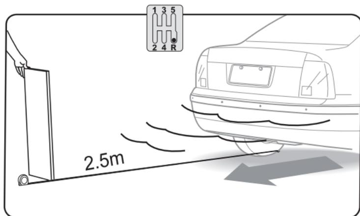
Проведіть функціональний тест, використовуючи дерев'яну дошку (0,3м x 1м), встановлену позаду автомобіля. Повільно сдаючи назад, перевірте працездатність кожної функції, яка вказана в цьому керівництві.
