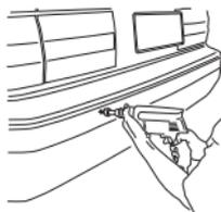
Электрической дрелью просверлите отверстие
